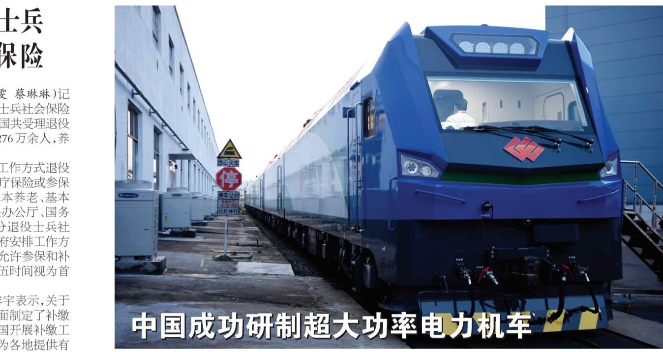
中国成功研制超大功率电力机车 7月29日,单机功率28800千瓦、牵引力2280千牛的“神24”电力机车在中车株洲电力机车有限公司下线。这一超大功率电力机车的成功研制,标志着中国铁路重载技术创新取得重大突破。图为“神24”电力机车。 新华社记者 薛宇舸 摄
